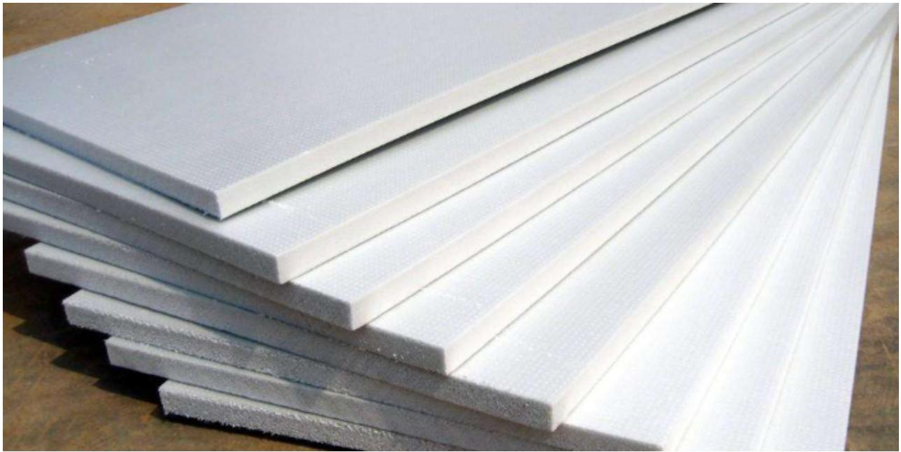
有机材料1、有机类保温材料主要有聚氨酯泡沫、聚苯板□EPS□XPS□酚醛泡沫等。2、有机保温材料具有重量轻、可加工性好、致密性高、保温隔热效果好，但缺点是：不耐老化、变形系数大、稳定性差、安全性差、易燃烧、生态环保性很差、施工难度大、工程成本较高，其资源有限，且难以循环再利用。3、传统的聚苯板、无机保温板具有的优异保温效果，在中国的墙体保温材料市场中广使用，但是不具备安全的防火性能，尤其是燃烧时产生毒气，其实此类材料的使用在发达国家早已经被限制在极小的应用领域。中国建筑物因大面积使用聚苯板保温材料所引发的火灾事故频发，造成了巨大的经济损失和人身伤亡。
